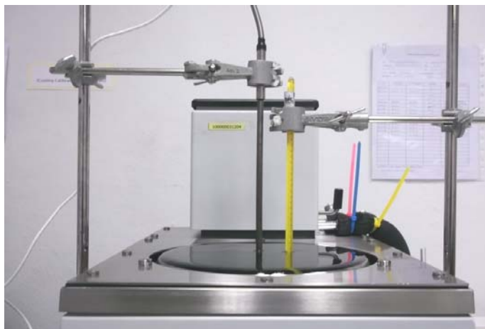
รูปที่ 2 การจุ่มเทอร์โมมิเตอร์มาตรฐาน และเทอร์โมมิเตอร์ชนิดแท่งแก้วที่นำมาสอบเทียบในอ่างสอบเทียบอุณหภูมิ
